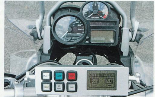
**Bedient wird die Beduin-Anlage einfach per Knopfdruck über ein Panel am Lenker**
